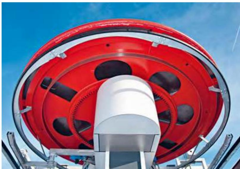
Auch in Sachen Antrieb eröffnen sich bei der Umsetzung eines fixen Sesselliftes verschiedenste Optionen. Ob in der Tal- oder in der Bergstation – Ausführungen als Unterflurantrieb oder Brückenantrieb sind ebenso möglich wie der als Standardkonfiguration vorgesehene Chair-Drive-Kompaktantrieb. Dieser zeichnet sich durch eine klare Anordnung der Komponenten und eine kompakte Bauweise aus. Montage und Transport sind dadurch sehr einfach und effizient.
